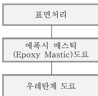
<그림 4.2.13> 보수도장 방법 개요도(재도장하는 경우)
